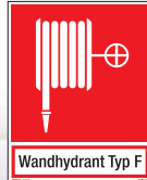
BGV A 8/F03 Löschschlauch mit Zusatz Wandhydrant Typ F
