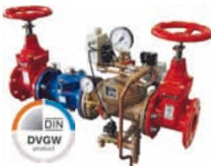
Füll- und Entleerungsarmatur auf Basis eines Membranventils mit integrierter Entleerungseinrichtung und Spüleinrichtung für die Membrankammer, Lieferung inklusive Absperrarmaturen vor und hinter dem Ventil sowie einem Rückflussverhinderer, Betriebsdruck 2 - 10 bar.
